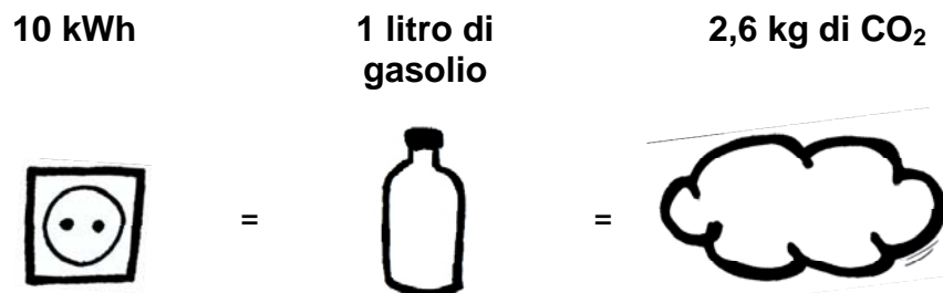
Figura 4: Rapporto tra lo sfruttamento energetico ed le emissioni di CO 2 nella combustione di 1 litro di gasolio
